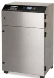
Každá jednotka je vybavena HCl a Senzory VOC, které nepřetržitě monitorují odpadní vzduch z jednotky, což poskytuje dodatečnou bezpečnost. Operační systém iQ nabízí pokročilé funkce, shromažďuje a analyzuje podrobná data, což umožňuje naplánovat výměnu filtrů v optimálním čase. Díky konektivitě rozhraní a vylepšenému dálkovému monitorování budete přesně vědět, co se v systému děje. Přesná diagnostika výrazně omezuje neplánované prostoje. Je ideální do průmyslového prostředí většího rozsahu.
